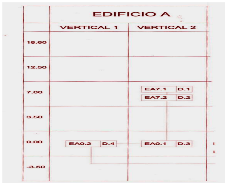
( Esquema con ubicación de los núcleos de control del sistema de tarjetas magnéticas )
